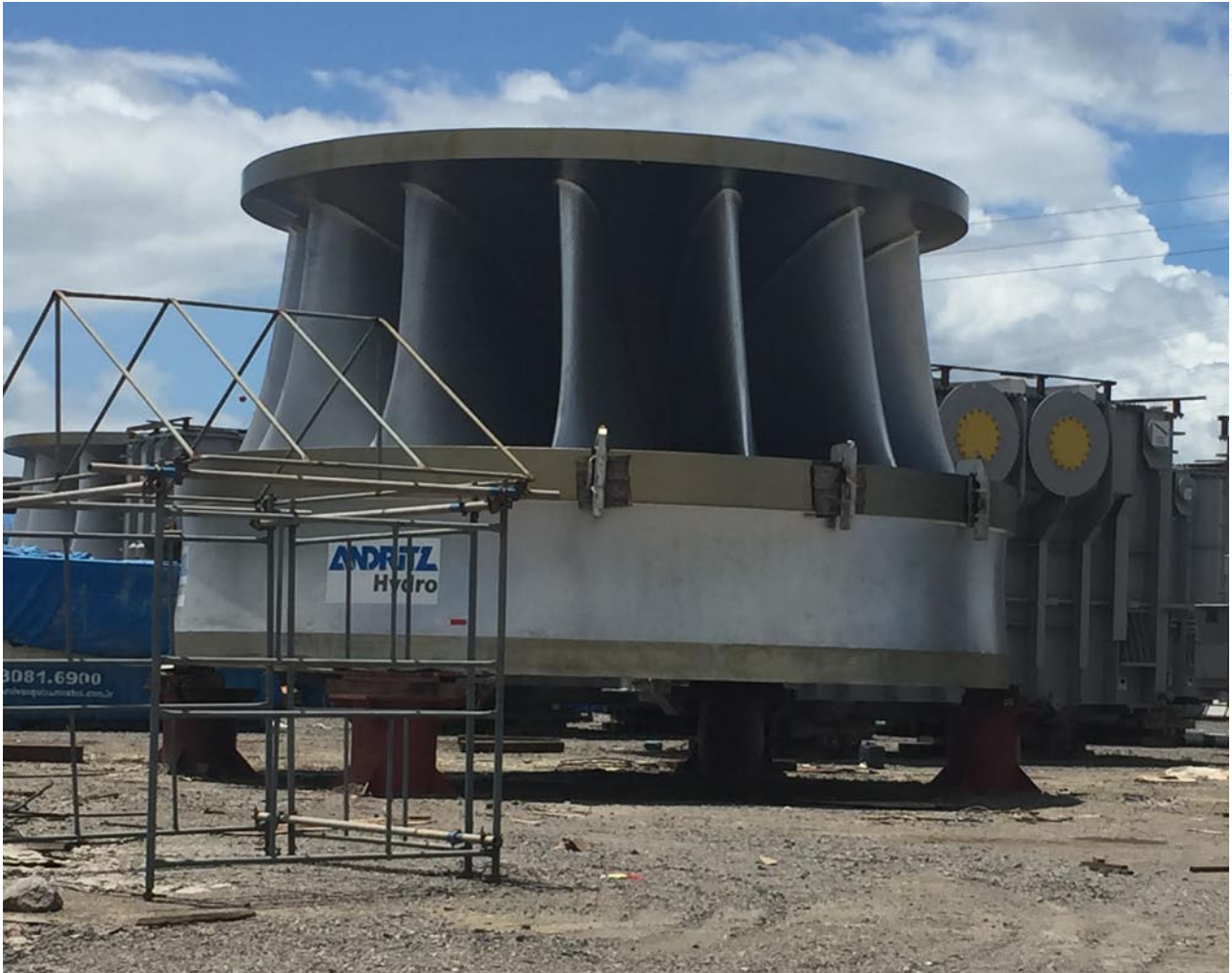
Eine Andritz-Turbine für das Belo-Monte-Wasserkraftwerk in Brasilien
