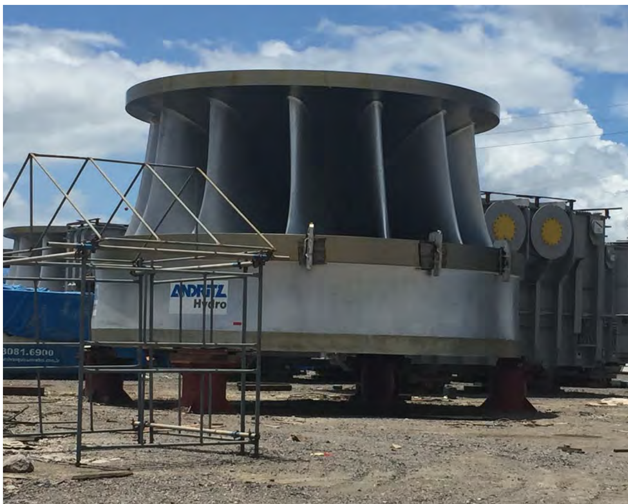
Eine Andritz-Turbine für das Belo-Monte-Wasserkraftwerk in Brasilien
